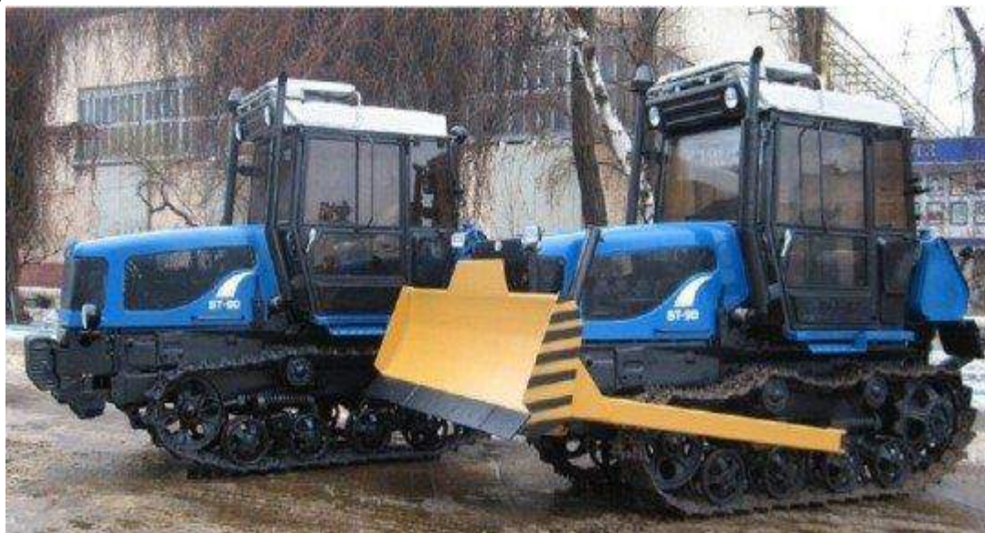
Рис.18. Трактор Агромаш 90ТГ гусеничный трактор, рестайлинг трактора ДТ-75.
