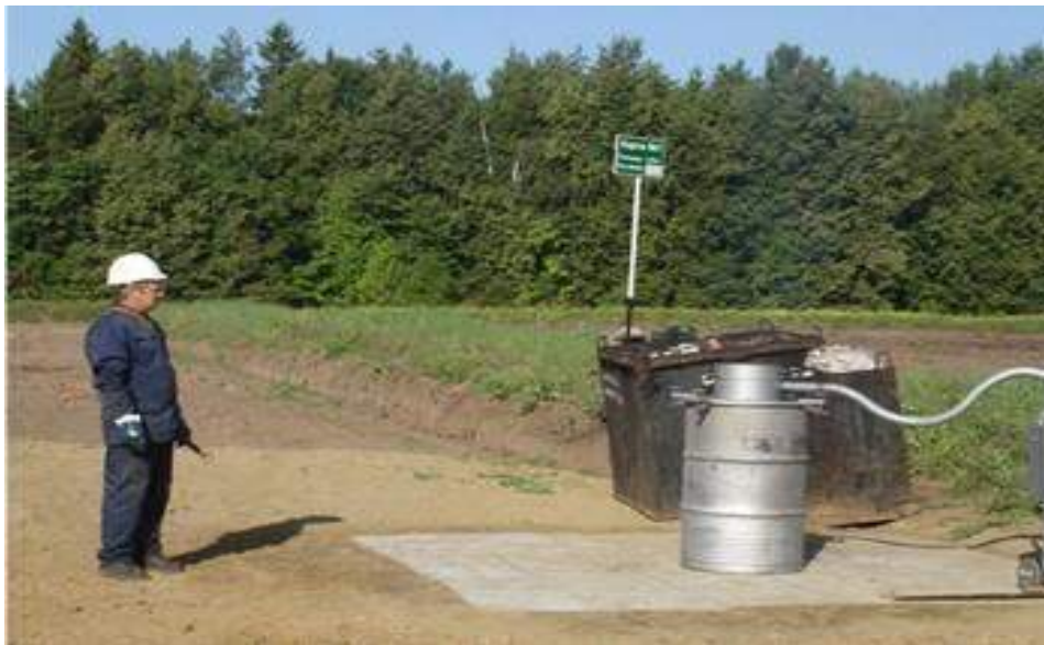
Рис. 16. Малогабаритная, передвижная установки для утилизации бытовых и промышленных отходов ЭКО "Ф-1" Форсаж.
